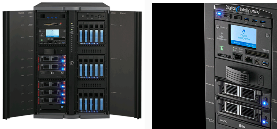
圖 10 FRED-SR 防寫主機
