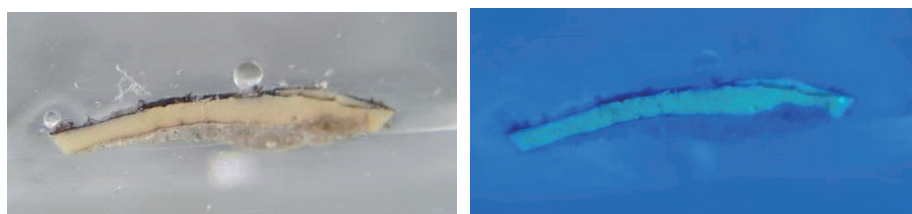
圖 20 編號 11 的彩繪切片可見光（左圖）及 UVF（右圖），50X。
