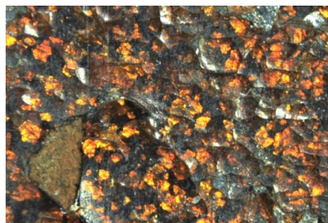
圖 20 微裂痕、漆層隆起與缺失（153 倍放大）。作者攝影。
