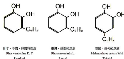
圖 3 不同種類的漆酚之化學結構。
